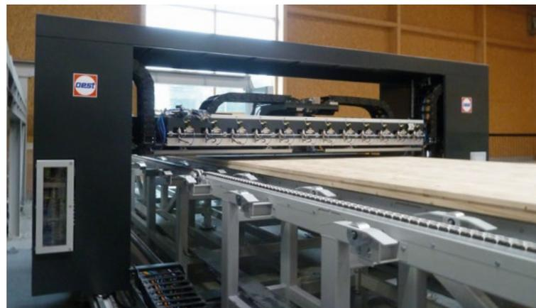
*Oest Belemigungsportal zur Herstellung von CLT Brettschichtholzplatten.*
